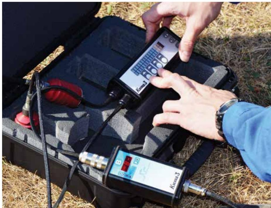
«Сейчас томограф проходит обкатку. Мы уже обследовали восемь участков на магистралях Воронежа. Прибор хорошо диагностирует новые трубопроводы, позволяет проверить качество монтажа», – рассказал начальник службы технического контроля и диагностики трубопроводов Теплосетей Воронежского филиала Сергей Калинин.
